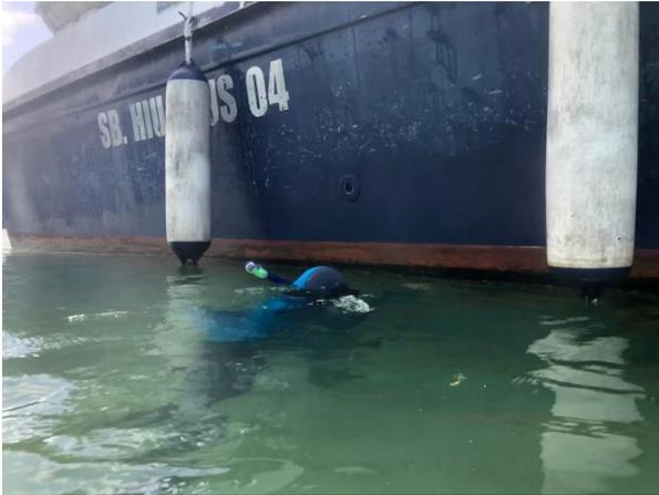
**Gambar 6.** Perawatan lambung kapal
